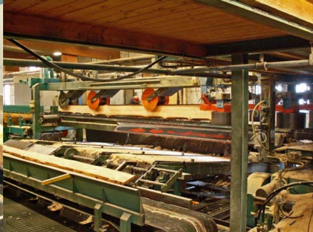
Figur 2.5: Utmatning stocksåg, notera blockets form efter stocksågen.
