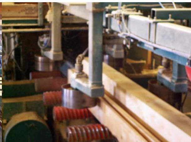
Figur 2.7: Utmatning blocksåg, notera blockets form efter blocksågen.
